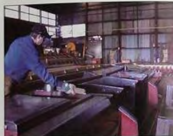
Abb. 5-5 Biegen von Stabstahl im Werk - Bieger auf Doppelbiegemaschine [Foto: Franz]
