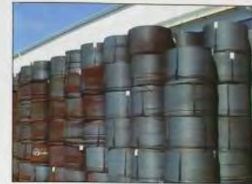
Abb. 5-6 Betonstahl Coil - Material TCA55 [Foto: Weiß/Sako]
