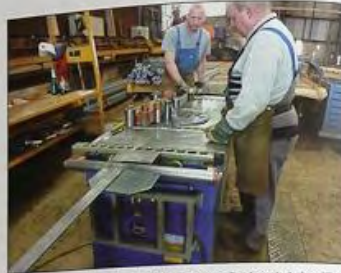
Abb. 5-4 Biegen von Stabstahl im Werk - Links: Bieger, Rechts: Anhalter [Foto: Hofstadler]
